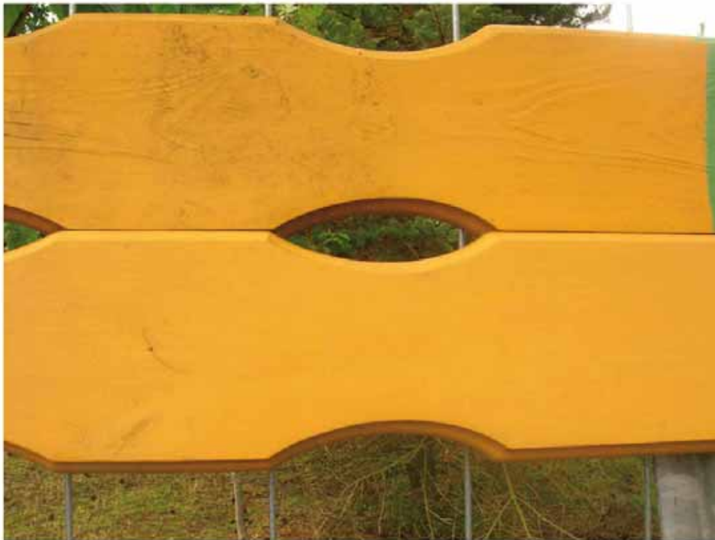
Oberes Holz: Pilzbefallener Anstrich ohne memon-Technologie nach 2 Jahren Außenbewitterung Unteres Holz: Intakter Anstrich einer informierten Wetterfarbe nach 2 Jahren Vollbewitterung
